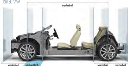
Der 2012 eingeführte modulare Querbaukasten von VW gilt als Pionier unter den Plattformen. Auch er war schon skalierbar.
